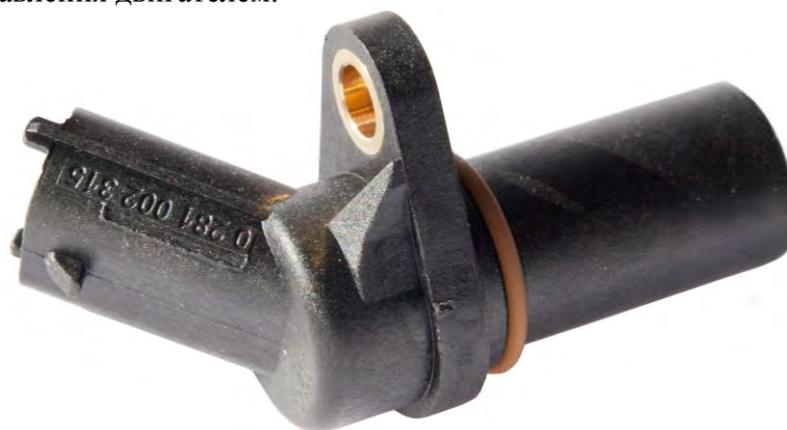
**Рисунок 10** - Датчик частоты вращения коленчатого вала DG6
